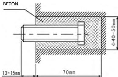
**3.1.3** Kun sementti on kovettunut, sovita kiinnityslevy (käytä aluslevyä ja mutteria noudattaen alla olevaa piirrosta).
