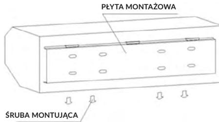
**3.1.2** Należy wywiercić otwory pod kołki rozporowe (ustalić ich położenie za pomocą płyty montażowej), które należy umieścić we właściwych miejscach.
