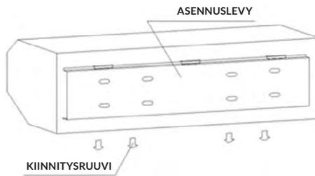
**3.1.2** Kiinnitä ruuvit oikeaan paikkaan (tarkista oikea paikka kiinnityslevyn avulla ja laita sementtiä pulttireikiin).
