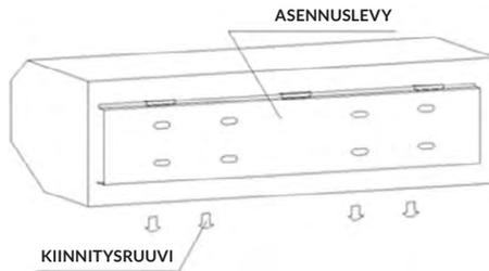
**3.3.2** Kattokiinnittimien asennus kuten kuvassa.
