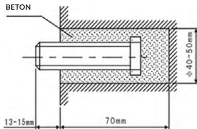
**3.1.3** Następnie przykręcić płytę montażową, stosując kotwy do betonu, podkładki i nakrętki zgodnie z poniższym rysunkiem.
