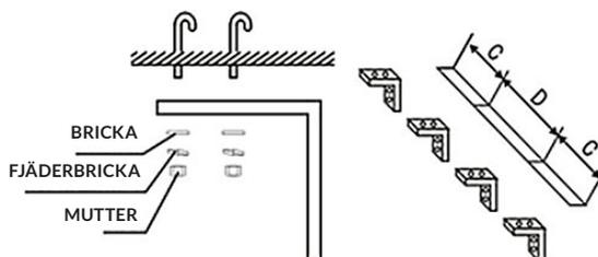
**3.3.3** Fastsätt monteringsplattan i takkonsolerna och säkerställ säker infästning (använd bultar som levererats tillsammans med takkonsolerna enligt fig.). Vid användande av takkonsoler för montering i taket kan monteringsplattan lägesjusteras inom 100 mm gränser.
