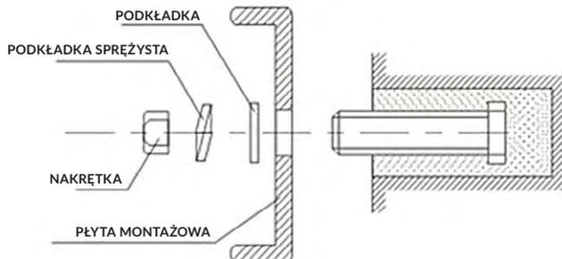
**3.1.4** Montaż urządzenia.
