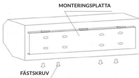
**3.1.2** Fixera bultarna i korrekt läge (bestäm läget med hjälp av monteringsplattan och fyll upp hålen för ankarbultarna med cement).
