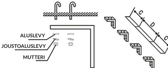
**3.3.3** Aseta asennuslevy kattokiinnittimiin, varmista kiinnitys ja turvallisuus (käytä mukana tulle-
