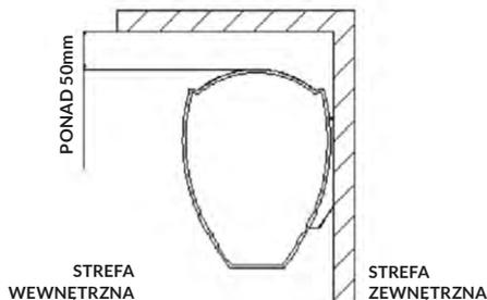
**2.3** Nie instalować urządzenia zbyt nisko, minimalna wysokość montażowa wynosi 2,3 metra.
