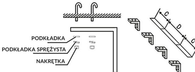
**3.3.3** Następnie założyć płytę montażową na przygotowane mocowania. Dokręcić płytę montażową do uchwytów sufitowych.
