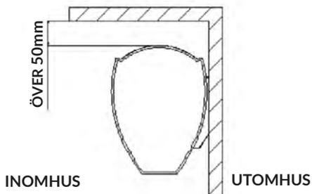
**2.3** Installera inte enheten för lågt, min. installationshöjd är 2,3 m över golvet.
