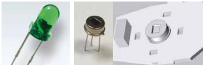
Czujnik nasłonecznienia Detekcja zmian nasłonecznienia.
