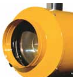
BV 400 standardowo wyposażony jest w wylot 1-drożny o średnicy 40 cm. Istnieje możliwość zastosowania wylotu 2-drożnego - średnica 2x31 cm (4034.480)
