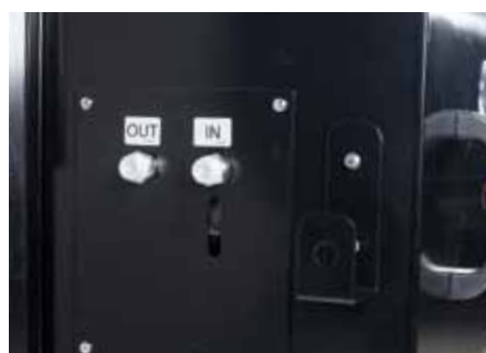
Łatwe podłączenie do zewnętrznego zbiornika paliwa
