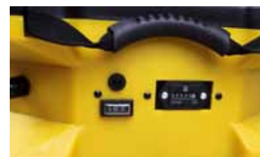
CDX 20 - panel sterujący, licznik roboczogodzin
