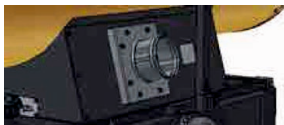
Opcjonalny zestaw umożliwiający podłączenie giętkiego przewodu doprowadzającego z zewnątrz powietrze do palnika. Zalecany w przypadku pracy nagrzewnicy w zanieczyszczonych pomieszczeniach.
