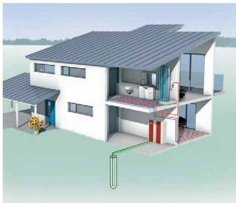
Pompy ciepła solanka/woda z sondami gruntowymi
