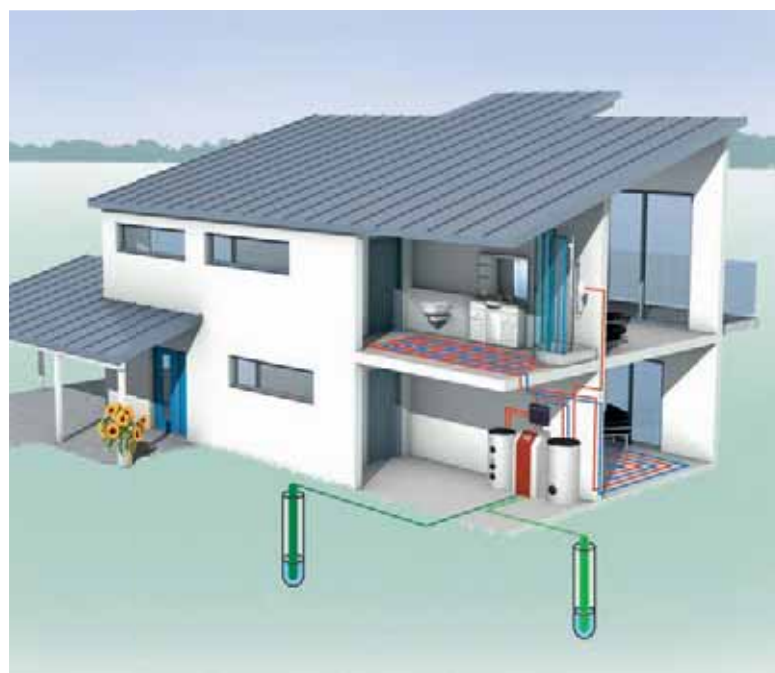
Pompa ciepła woda/woda ze studniami
