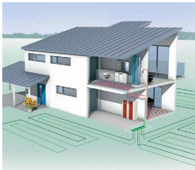
Pompy ciepła solanka/woda z kolektorami gruntowymi
